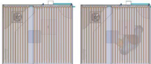
(e) 顶部空气源蒸发器和冷凝器俯视图
